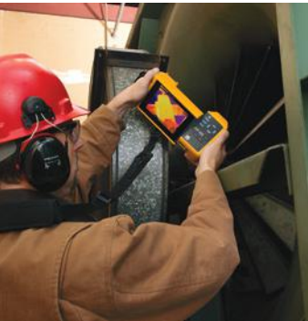
240° 회전 렌즈로 다양한 위치에서 편한 각도로 촬영할 수 있으며 태블릿 크기의 5.7 inch LCD 화면을 제공합니다.
