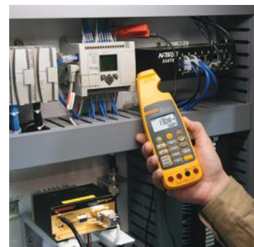
루프 단선 없이 프로세스 및 다른 오토메이션의 4~20 mA 신호 측정을 합니다.
