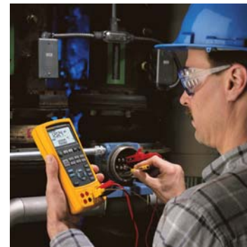
Fluke 725 및 726 교정기로 트랜스미터의 온도를 쉽게 교정합니다.
