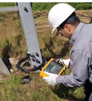
송전탑의 접지 루프 측정을 위한 변압기 액세스리 클램프
