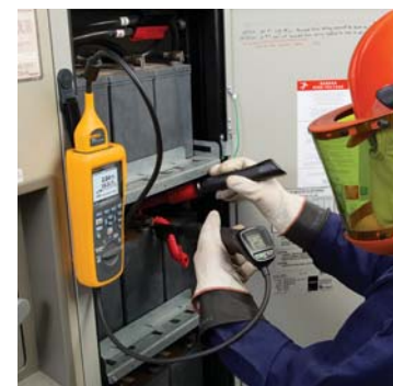
Fluke BT521 배터리 분석기로 임피던스 측정
