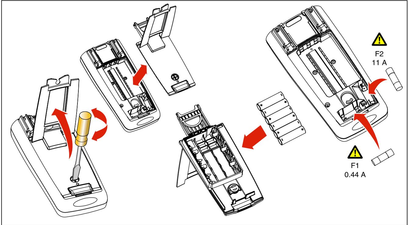
그림 30. 배터리 및 퓨즈 교체
