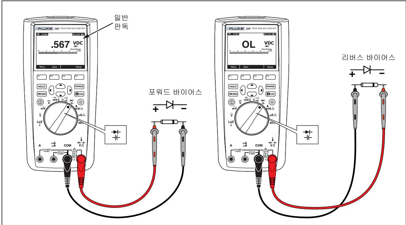
그림 20. 다이오드 테스트
