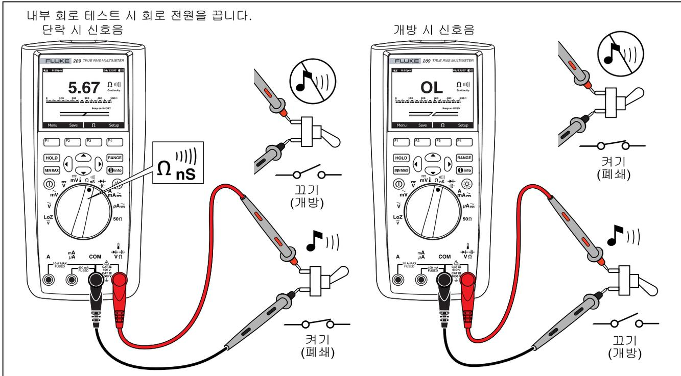
그림 17. 연속성 테스트
