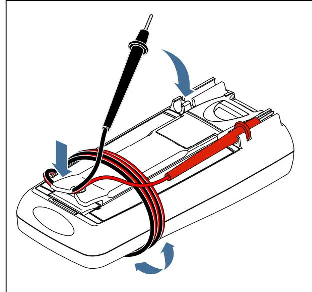
그림 29. 테스트 리드 보관
