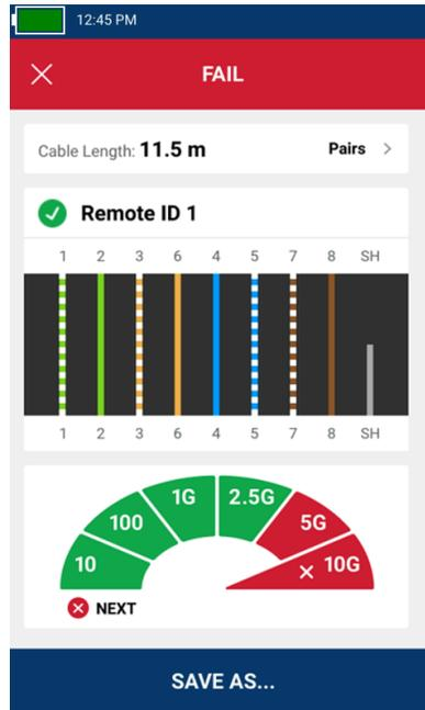
원격 연결된 케이블 테스트는 최대 2.5Gb/s의 각 와이어 및 케이블 성능의 원격 ID 번호 1, 길이 및 페어링을 보여주지만 10Gb/s 성능의 사용자 설정 제한으로 인해 테스트에 실패했습니다.
