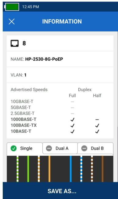
스위치 포트 테스트는 포트 번호, 스위치 이름 및 포트 VLAN을 알려진 속도 및 이중성 설정과 함께 표시합니다. 아래로 스크롤하면 *Power over Ethernet* 결과가 표시됩니다.
