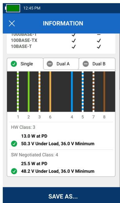
스위치 포트 PoE(Power over Ethernet)를 설정하면 사용된 페어, 사용 가능한 파워 및 클래스, 부하 상태의 PoE 테스트 결과가 보입니다.
