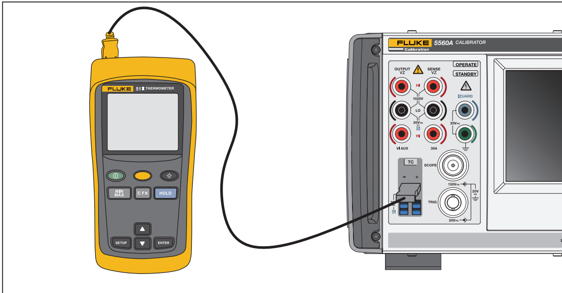
그림 14.50 시리즈 온도계 테스트를 위한 케이블 연결
