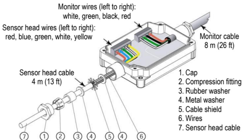
**Figure 33: Laser Switching Box**
