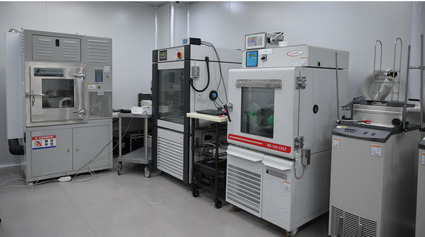
그림 4. (주)테솔의 ISO/IEC 17025 공인 환경 분야 온도·습도·압력 고정밀 검증 장비 및 교정실 현장
