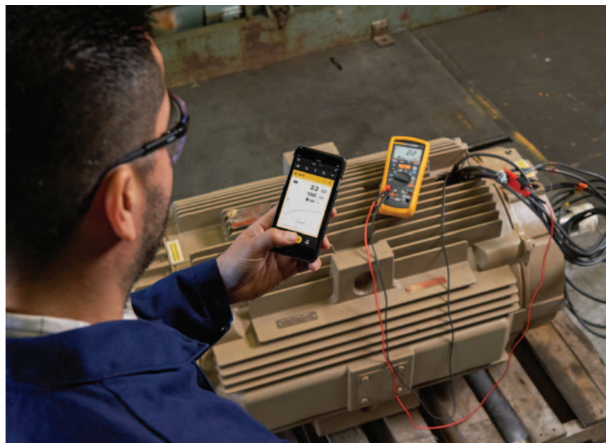
Fluke Connect 측정 앱에서 Fluke 1587 FC를 사용하여 데이터 저장 및 공유.
