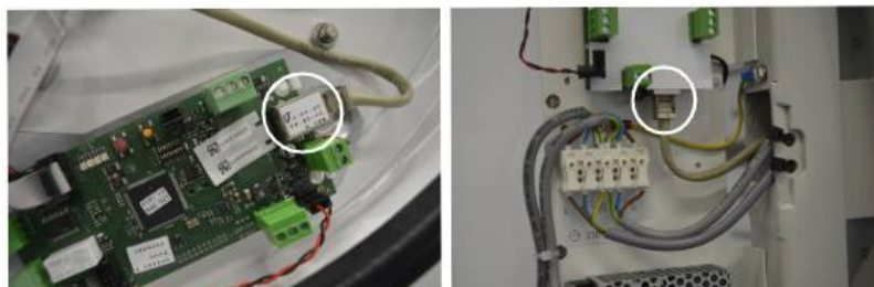
Port Ethernet RJ45 : Simple face (à gauche) et Double face (à droite)
